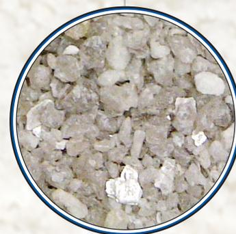
Semi roulé Quartz extra siliceux Vrac Big Bag Béton esthétique, enduit
