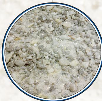
Semi roulé Quartz siliceux avec mica Vrac Big Bag Béton esthétique
