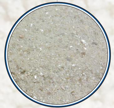
Semi roulé    Quartz siliceux avec mica    Vrac Big Bag    Béton esthétique, golf, enduit, équitation
