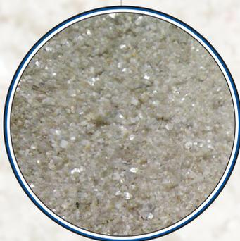
Semi roulé Quartz siliceux avec mica Vrac Big Bag Béton esthétique, golf, enduit
